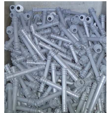
Abstandshalter der Firma TrainottiPlast für Stalbetonwände aus recycelten Flaschenverschlüssen der Sammelaktionen. F: (3): Atkary
